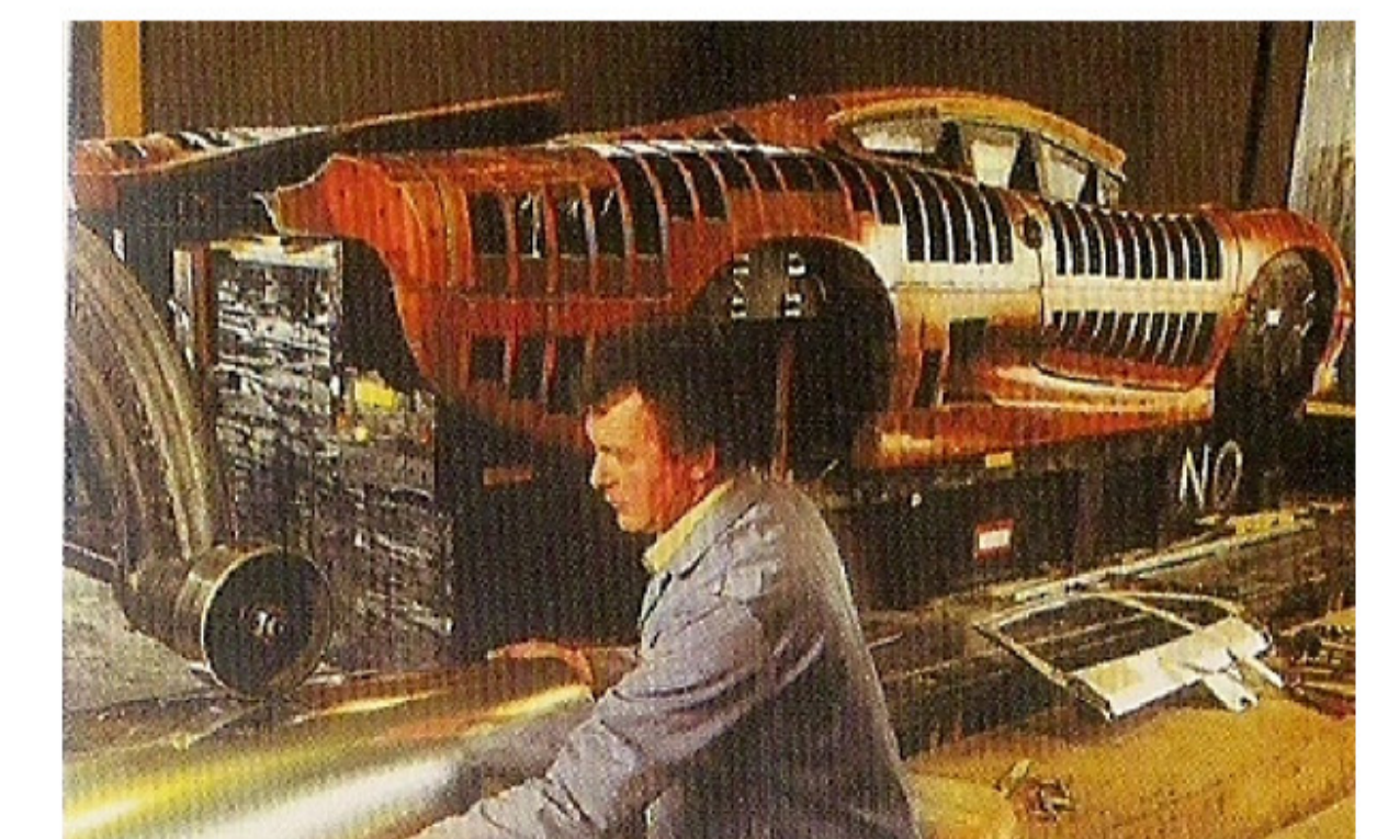
FORD SALEEN S-7: MODELO DE MADERA QUE REPRODUCE LAS DIFERENTES SECCIONES TRANSVERSALES QUE RECONSTRUYEN LAS CURVAS SUAVES DE ESTE SUPER DEPORTIVO AMERICANO. TRADICIONALMENTE ESTOS MODELOS HAN SERVIDO A LOS CHAPISTAS PARA DAR FORMA DEFINITIVA A LA CARROCERÍA.
