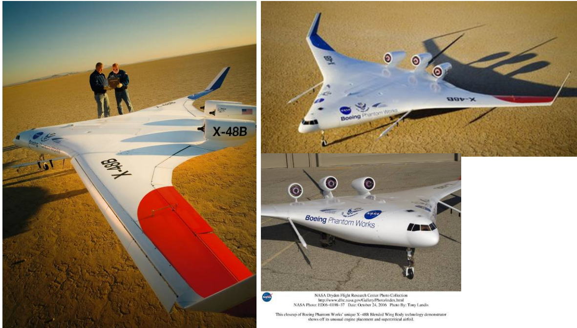
Prototipo X-48B a escala 8,5% del futuro avión de pasajeros de la Boeing.
